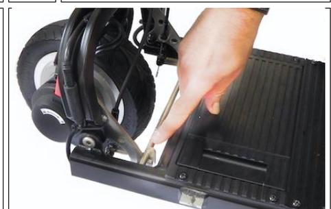
**9** Stellen Sie sicher, dass die Verriegelungsklinken an der Stahlstange eingerastet sind...
