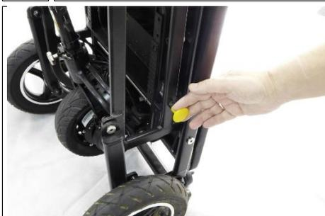
**5** Lokalisieren Sie den kleinen gelb Stopper an der Seite und ziehen Sie daran, um die Vorderradbaugruppe zu lösen.
