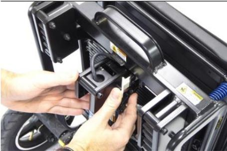
**1** Lenksäulenverriegelung lösen...
